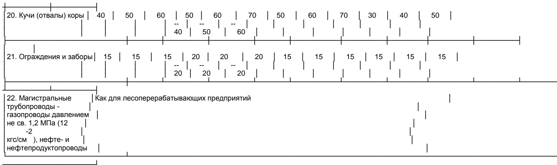
Противопожарные расстояния от открытых и закрытых складов лесоматериалов до складов ГЖ определяются из расчета: 1 м3 ЛВЖ приравнивается к 5 м3 ГЖ, и 1 м3 ГЖ наземного хранения приравнивается к 2 м3 ГЖ подземного хранения.
