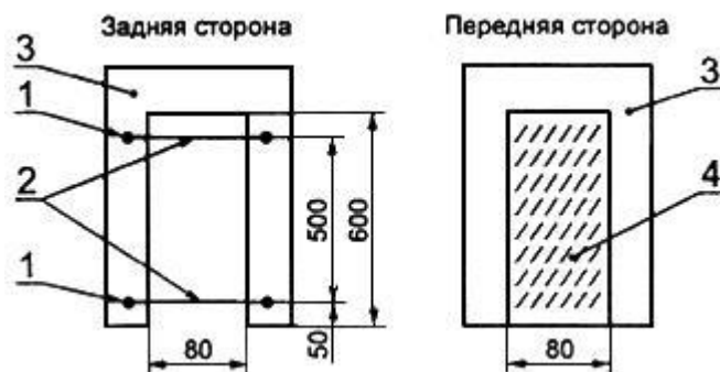
Черт.15. Держатель U-образный для образца
