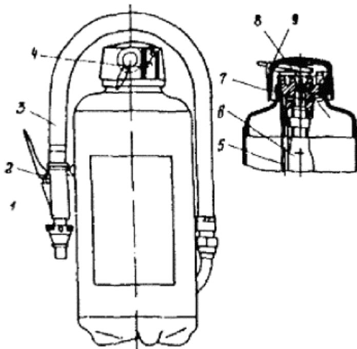
**Рис. 12. Общий вид ручного порошкового огнетушителя ОП-5:**
