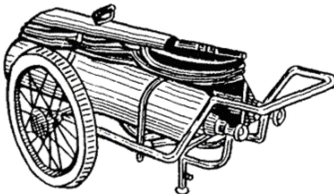
**Рис. 9. Передвижной углекислотный огнетушитель ОУ-80**
