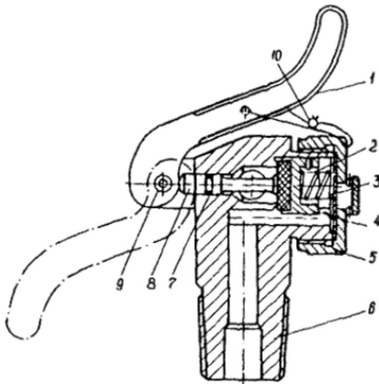
**Рис. 10. Запорно-пусковое устройство рычажного типа УН-52:**
