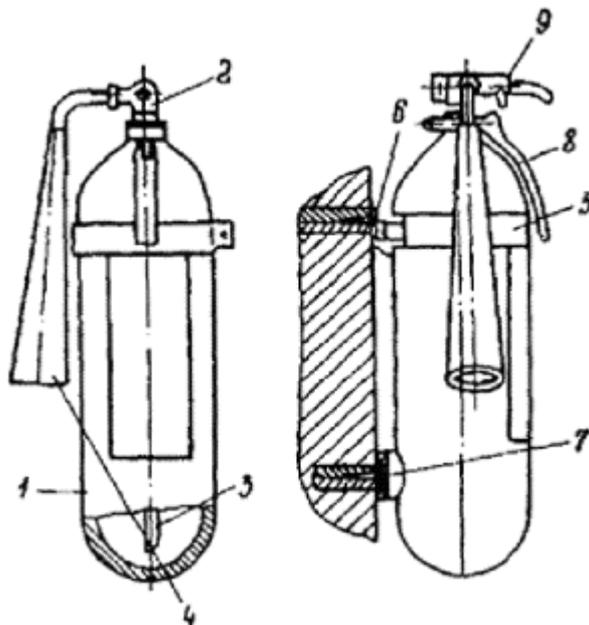
**Рис. 7. Ручной углекислотный огнетушитель ОУ-5 (ОУ-8):**
