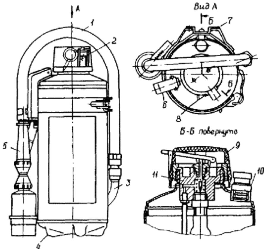
**Рис. 3. Ручной воздушно-пенный огнетушитель ОВП-10:**
