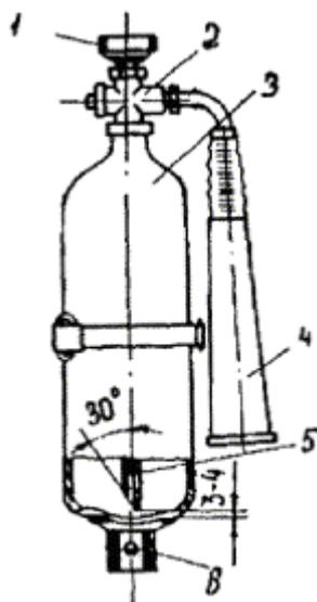
**Рис. 6. Ручной углекислотный огнетушитель ОУ-2:**
