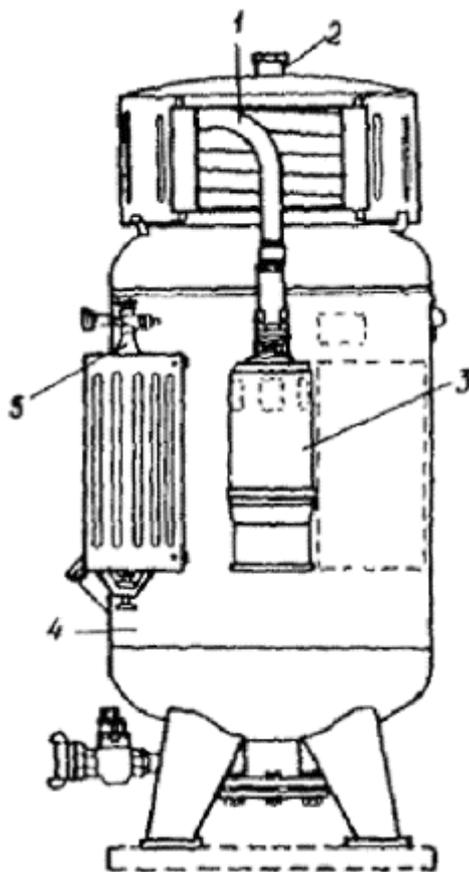
**Рис. 5. Стационарный воздушно-пенный огнетушитель ОВПУ-250 (УВП-250):**
