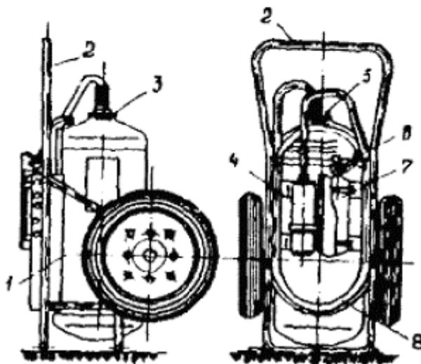
**Рис. 4. Передвижной воздушно-пенный огнетушитель ОВП-100:**
