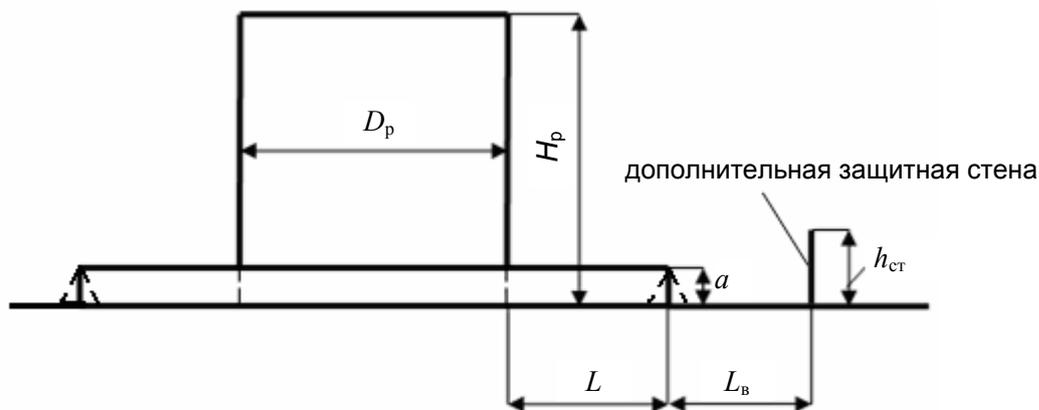
Рисунок Б.1 — Расчетная схема дополнительной защитной стены
