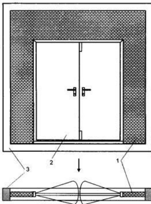
1 - фрагмент ограждающей конструкции; 2 - образец для испытания; 3 - рама для установки фрагмента ограждающей конструкции; ↓ - направление теплового воздействия
