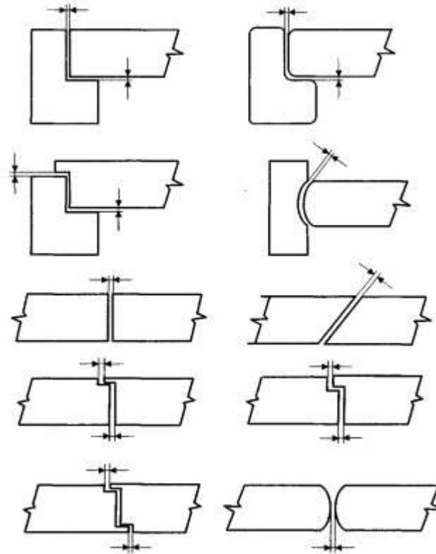
Рисунок 25 - Примеры замеров зазоров распашных дверей (горизонтальное сечение)
