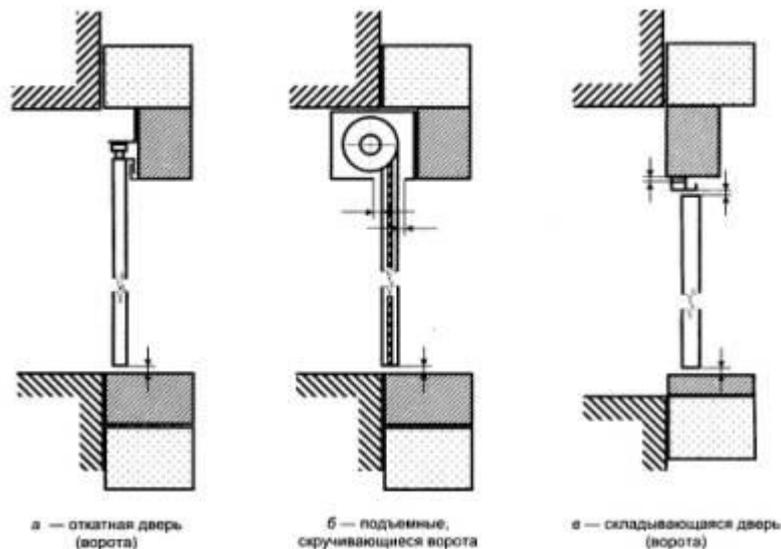
**Рисунок 27 - Примеры замеров зазоров (вертикальное сечение)**
