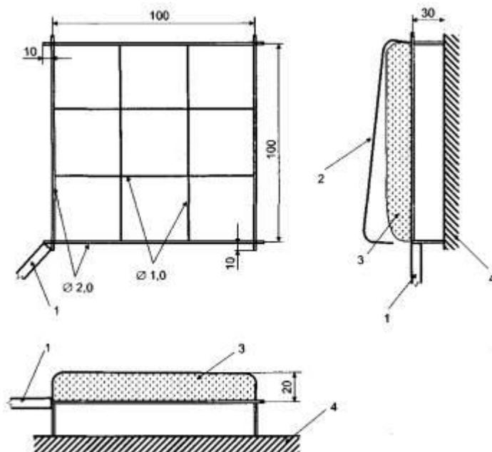
1 - ручка; 2 - зажим (открыто); 3 - ватный тампон; 4 - поверхность испытанного образца
