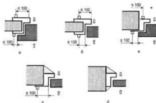
□ - место установки термодатчика; ↑ - вид с необогреваемой стороны
