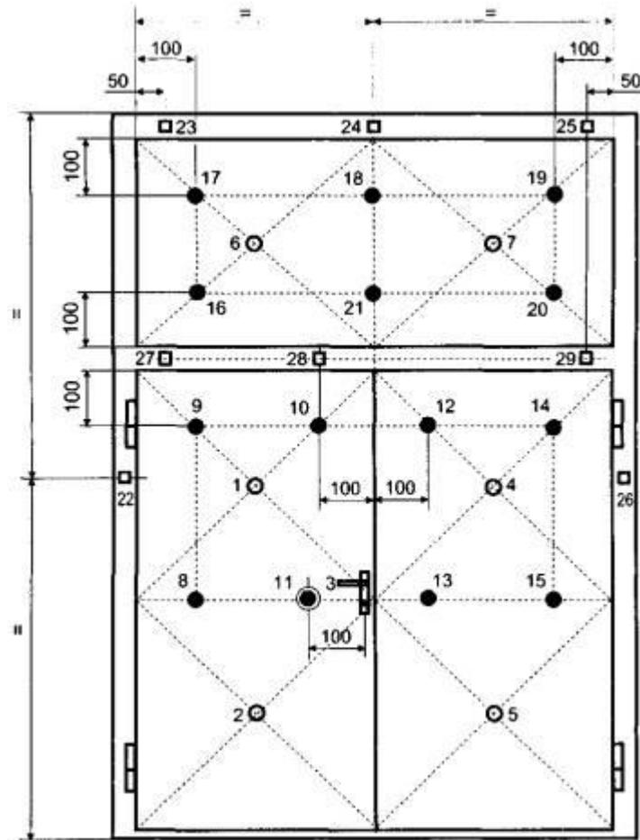
**Рисунок 19 - Схема установки термодпар на необогреваемой поверхности распашной двупольной двери с симметричными полотнами по ширине и с фрамугой**
