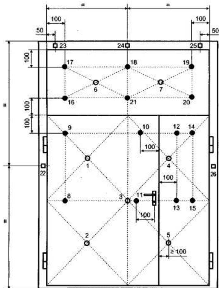
Рисунок 18 - Схема установки термодатчиков на неотапливаемой поверхности распашной двупольной двери (ширина полотен различная) с фрамугой
