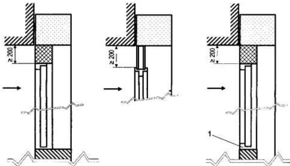
1 - фрагмент ограждающей конструкции; → - направление теплового воздействия
