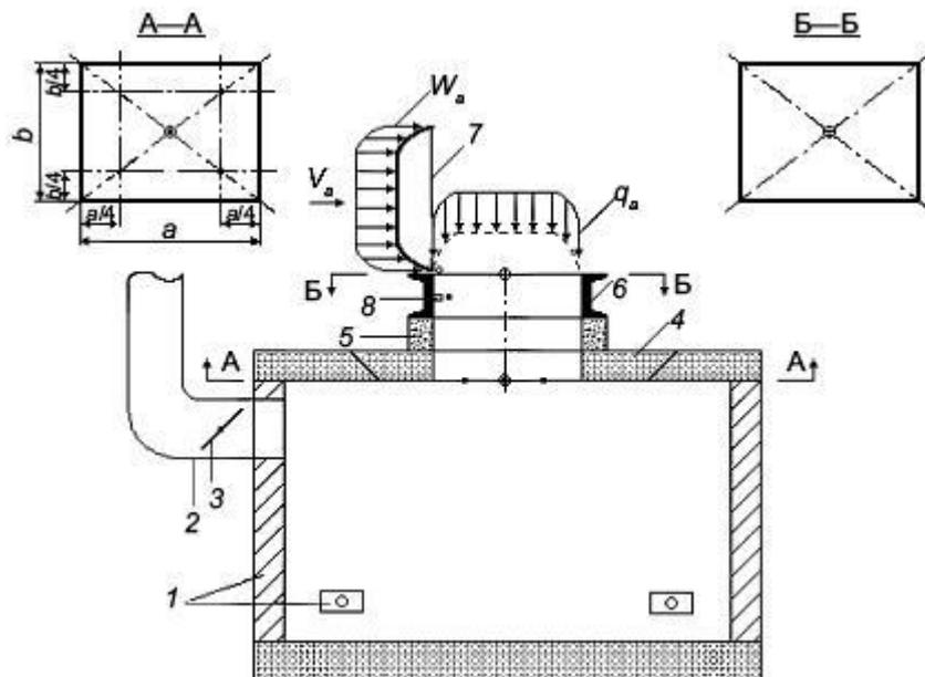
1 - печь с форсунками; 2 - дымоход; 3 - шибер; 4 - вкладыш покрытия печи; 5 - установочный элемент; 6 - корпус дымового клапана; 7 - заслонка дымового люка; 8 - термоэлемент привода; - термоэлектрический преобразователь; - место измерения статического давления; - комбинированный приемник давления; - скорость ветра (воздушного потока); - ветровая нагрузка; - механическая нагрузка.
