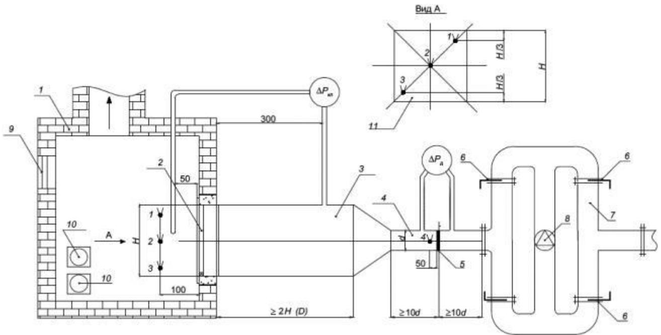
1 - печь; 2 - клапан; 3 - переходник; 4 - мерный участок воздуховода; 5 - диафрагма; 6 - регулирующая заслонка; 7 - обвязка вентилятора; 8 - вентилятор; 9 - иллюминатор; 10 - форсунка; 11 - схема расположения ТЭП в печи относительно клапана
