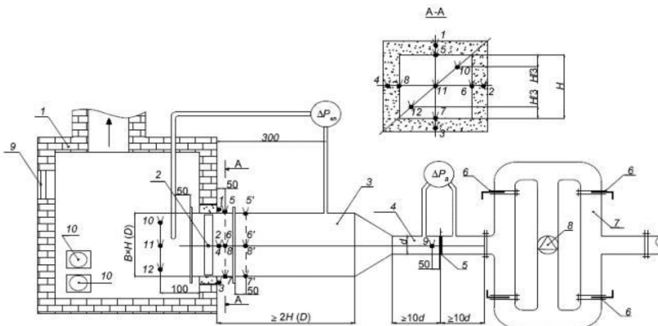
1 - печь; 2 - клапан; 3 - воздуховод; 4 - мерный участок воздуховода; 5 - сегментная диафрагма; 6 - регулирующая заслонка; 7 - обвязка вентилятора; 8 - вентилятор; 9 - иллюминатор; 10 - форсунка
