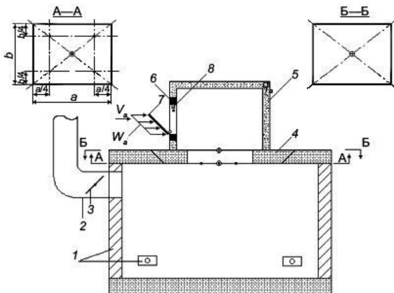
1 - печь с форсунками; 2 - дымоход; 3 - шибер; 4 - вкладыш покрытия печи; 5 - установочный элемент; 6 - корпус дымового клапана; 7 - заслонка дымового люка; 8 - термоэлемент привода; - термоэлектрический преобразователь; - место измерения статического давления; -
