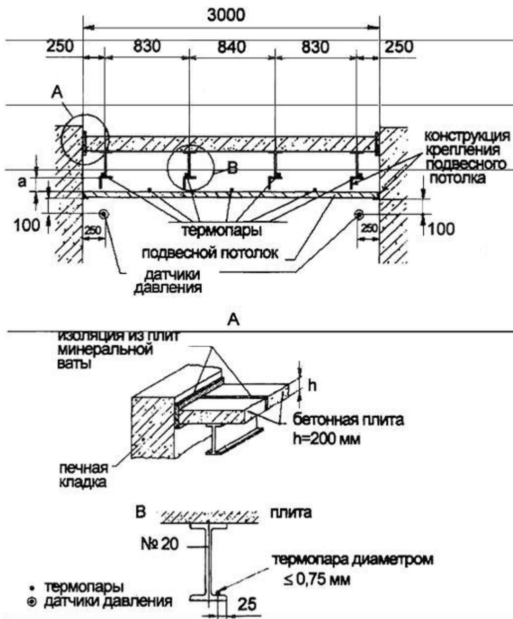
Рисунок А.1 - Схема испытательного блока
