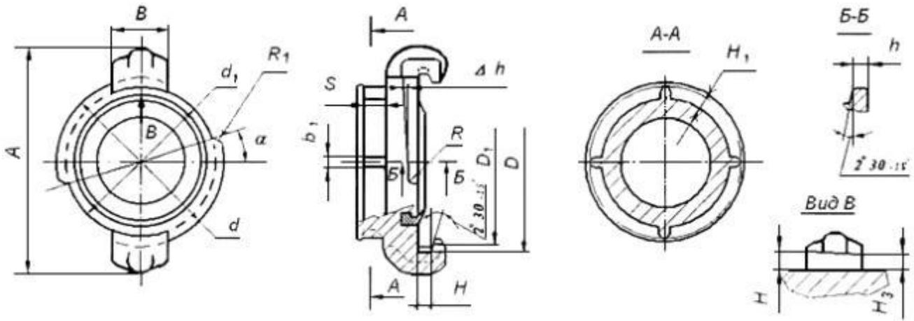
Примечание - Угол наклона 2°30" на диаметрах , - рекомендуемый.
