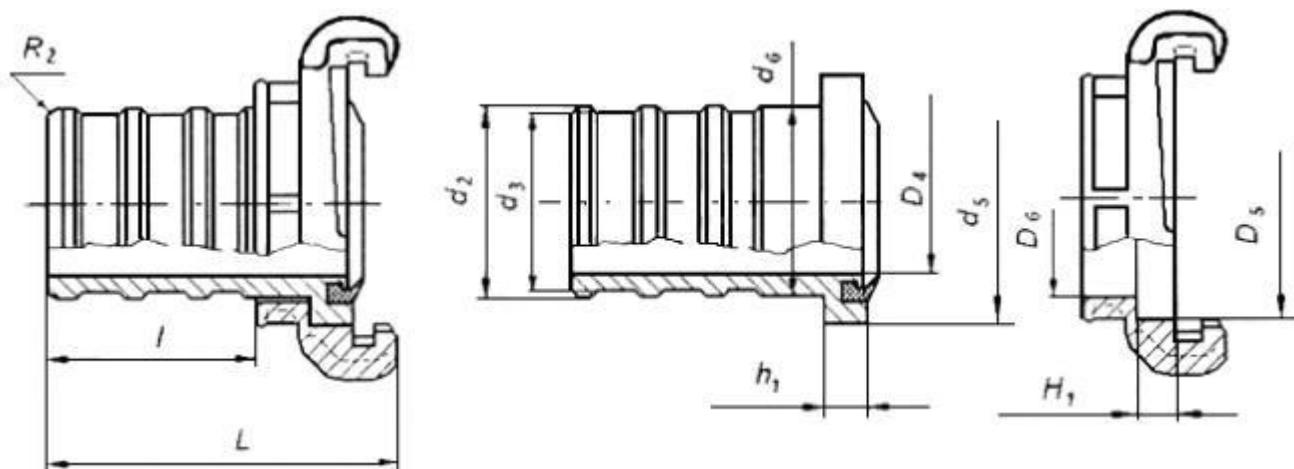
Рисунок 2 - Рукавная напорная головка
