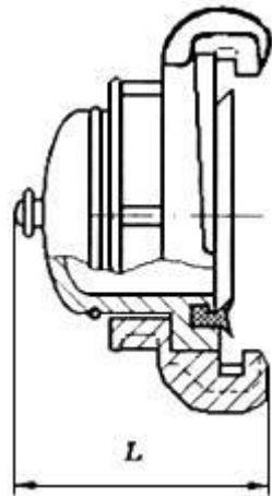
Рисунок 9 - Всасывающая головка-заглушка
