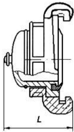
Рисунок 6 - Напорная головка-заглушка
