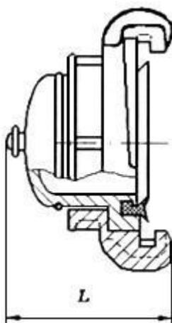
Рисунок 9 - Всасывающая головка-заглушка
