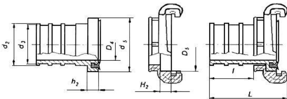
Рисунок 7 - Рукавная всасывающая головка
