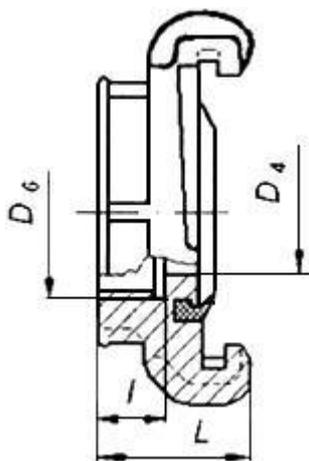
Рисунок 3 - Муфтовая напорная головка
