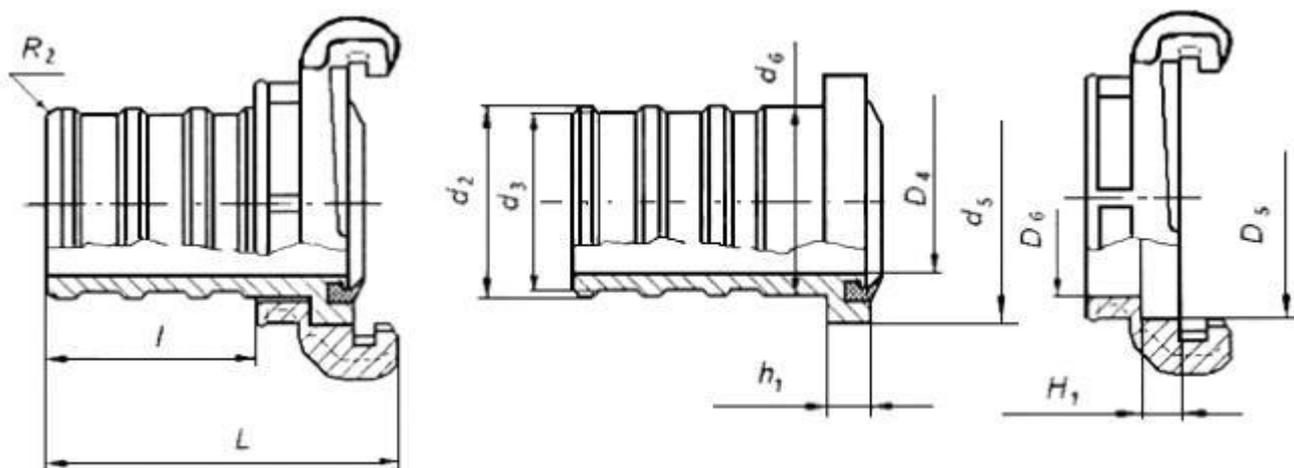
Рисунок 2 - Рукавная напорная головка
