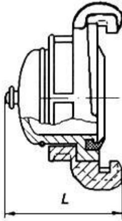
Рисунок 6 - Напорная головка-заглушка
