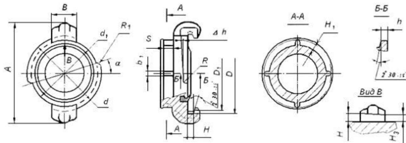
Примечание - Угол наклона  $2^{\circ}30'$  на диаметрах , , рекомендуемый.
