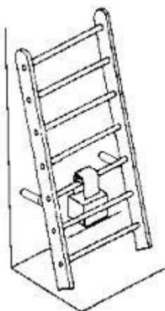
Рисунок 5 - Схема установки или подвески контрольного груза
