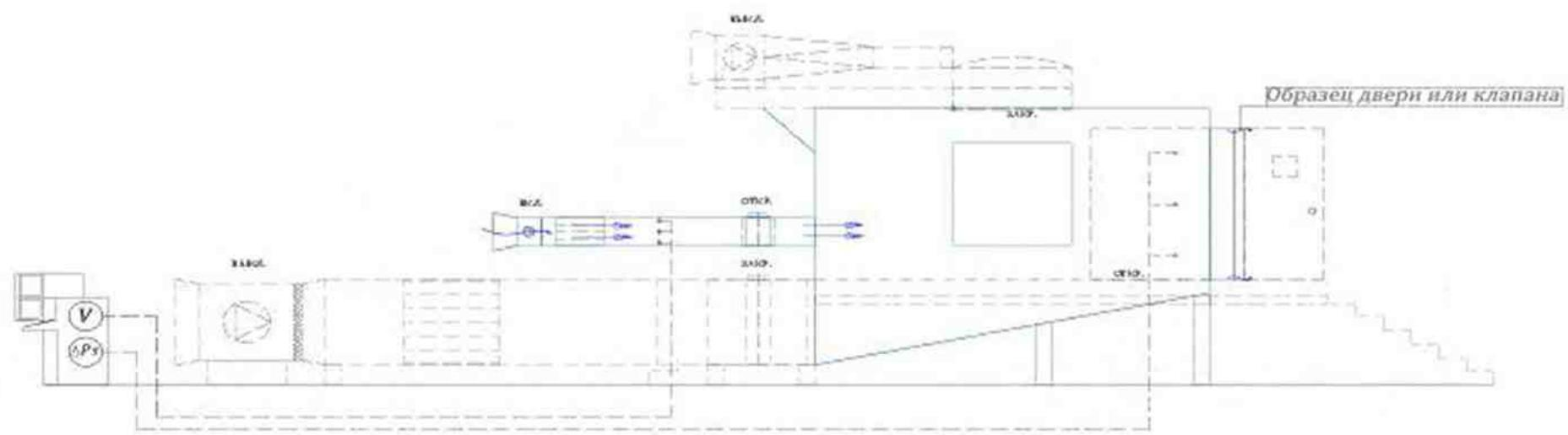
Рисунок А.3 – Схема проведения испытаний по определению фактических значений сопротивления воздухопроницанию
