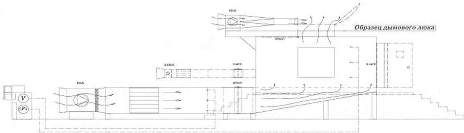
Рисунок А.2 – Схема проведения испытаний по определению коэффициента расхода
