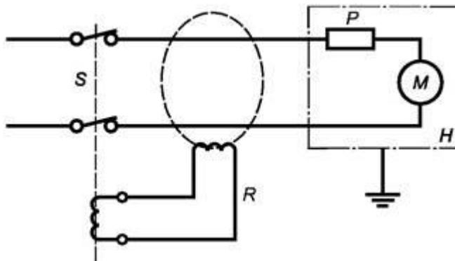
S - источник питания; H - корпус; R - устройство остаточного тока ( $I_{Dn} = 30$  мА); P - устройство тепловой защиты двигателя (наружное или внутреннее), если имеется; M - двигатель
