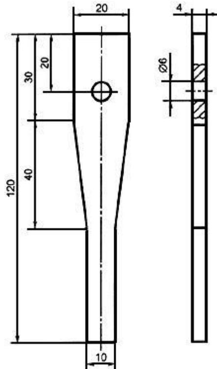
Рисунок 1.3 - Стальная пружина
