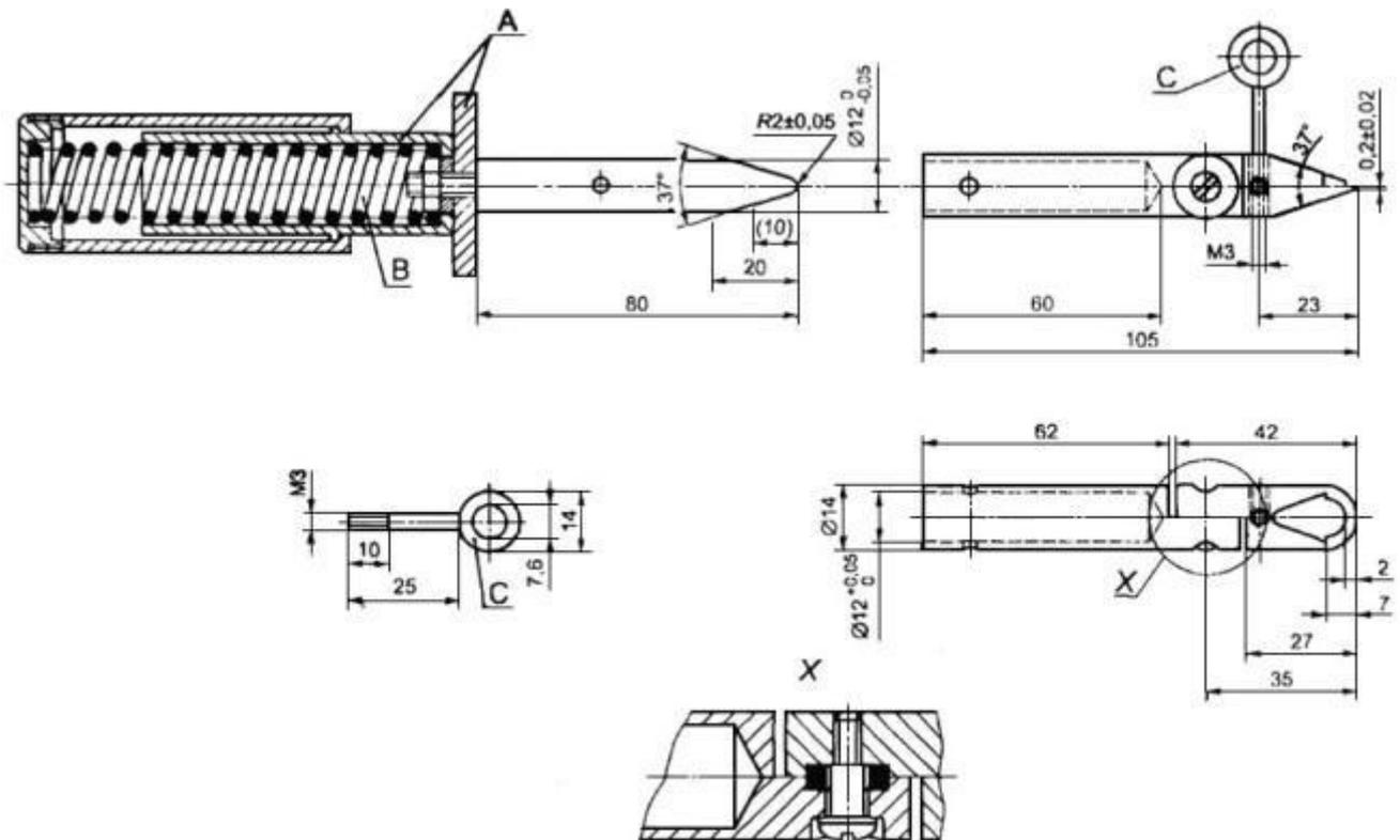
А - изоляционный материал; В - пружина с коэффициентом упругости, подходящим для обеспечения толкающей силы на испытательном ногте, указанной в 22.11; С - петля
