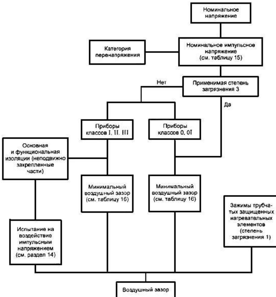
Рисунок L.1 - Последовательность операций при определении **воздушных зазоров**
