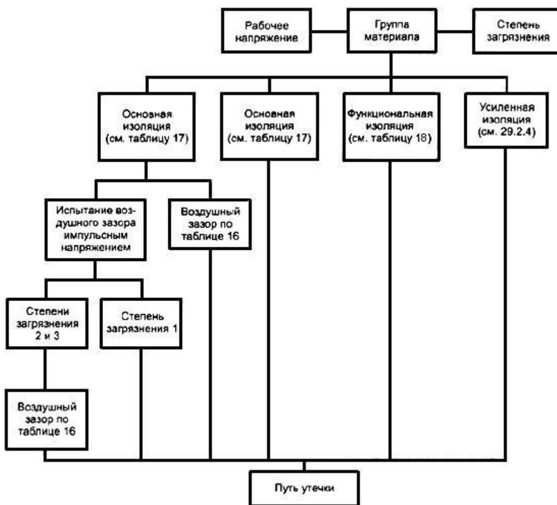
Рисунок L.2 - Последовательность операций при определении путей утечки
