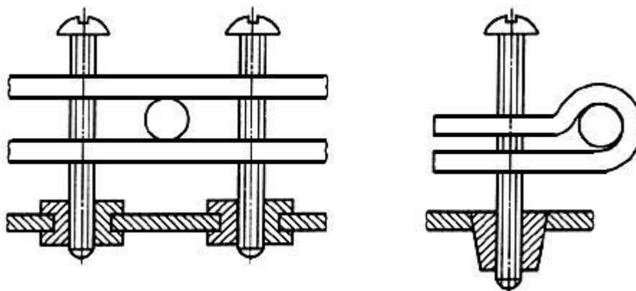
Конструкции, не имеющие части, жестко закрепленной на приборе
