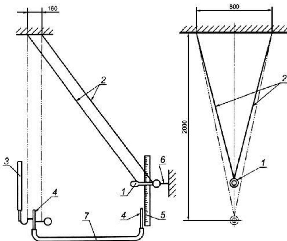
1 - ударный элемент; 2 - льняные нити; 3 - пружина; 4 - стеклянные трубки; 5 - шкала; 6 - тонкая нить; 7 - гибкий шланг
