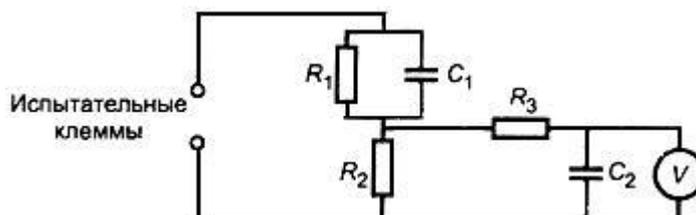
$R_1 = 1500 \text{ Ом} \pm 0,1\%$ ;  $R_2 = 500 \text{ Ом} \pm 0,1\%$ ;  $R_3 = 10 \text{ кОм} \pm 0,1\%$ ;
