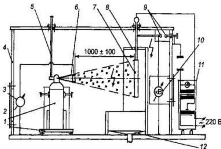
1 - изолирующая подставка; 2 - испытываемый огнетушитель; 3 - измеритель тока утечки; 4 - защитный каркас испытательного стенда; 5 - устройство дистанционного запуска огнетушителя; 6 - насадка огнетушителя с электропроводящим элементом; 7 - мишень; 8 - экран; 9 - разрядник; 10 - киловольтметр; 11 - источник высокого напряжения; 12 - емкость для сбора отработанного ОТВ
