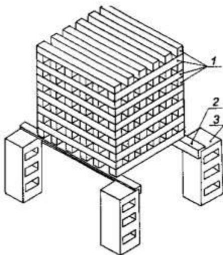
1 - деревянные бруски; 2 - стальной уголок; 3 - бетонный (металлический) блок
