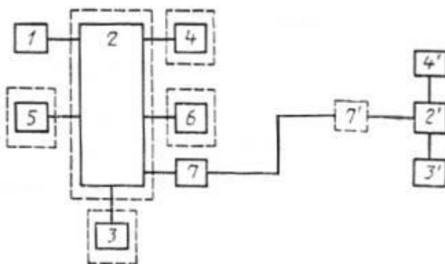
1 - извещатель; 2, 2 φ - установка управления; 2 - охранный (охранно-пожарный) приемно-контрольный прибор, 2 φ - пульт централизованного наблюдения; 3, 3 φ - пульт централизованного наблюдения; 4, 4 φ - световой и (или) звуковой оповещатель; 5 - устройство, управляемое установкой управления; 6 - программируемое входное устройство; 6 - шифрующее устройство; 7, 7 φ - сигнальный интерфейс (модем); 7, 7 φ - система передачи извещений
