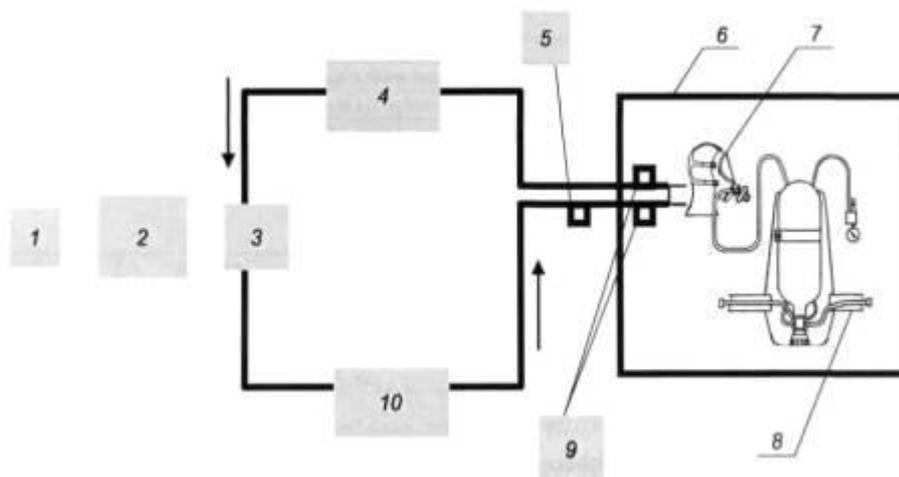
1 - привод насоса «искусственные легкие»; 2 - насос «искусственные легкие»; 3 - клапанная коробка с клапанами вдоха и выдоха; 4 - осушитель; 5 - датчики температуры и влажности; 6 - климатическая камера; 7 - «Шеффилдский» муляж головы человека; 8 - дыхательный аппарат; 9 - датчики сопротивления дыханию; 10 - термостат с увлажнителем
