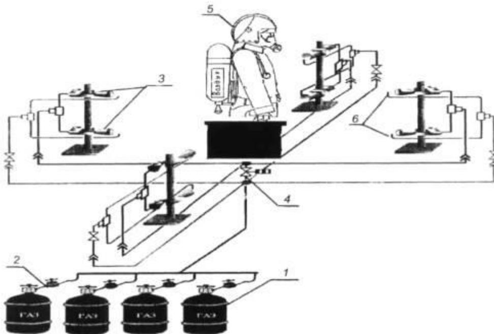
1 - баллоны газовые; 2 - редуктор; 3 - горелки газовые; 4 - клапан электромагнитный; 5 - манекен с аппаратом дыхательным; 6 - система поджига
