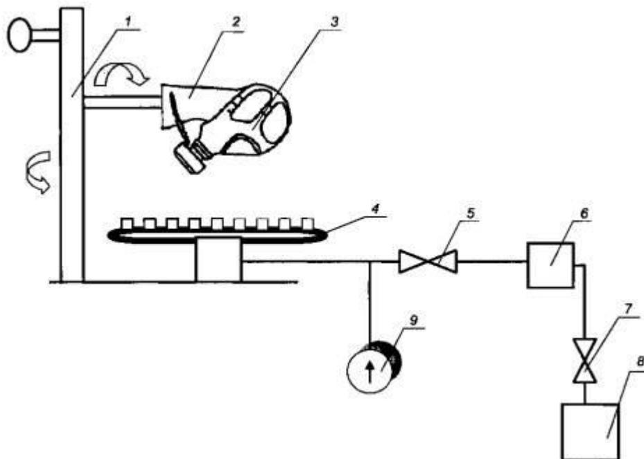
1 - стойка с ложементом для подвода самоспасателя в зону пламени; 2 - металлический муляж головы человека; 3 - капюшон (лицевая часть); 4 - горелка с форсунками; 5, 7 - вентили; 6 - редуктор; 8 - баллон с пропаном; 9 - прибор для измерения давления газа
