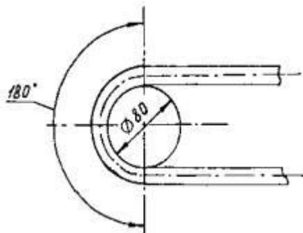
**Рисунок 5 - Схема определения работоспособности воздуховодного шланга**
