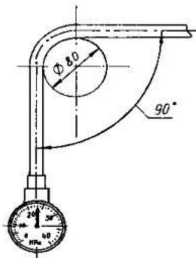
**Рисунок 6 - Схема определения работоспособности шланга высокого давления**
