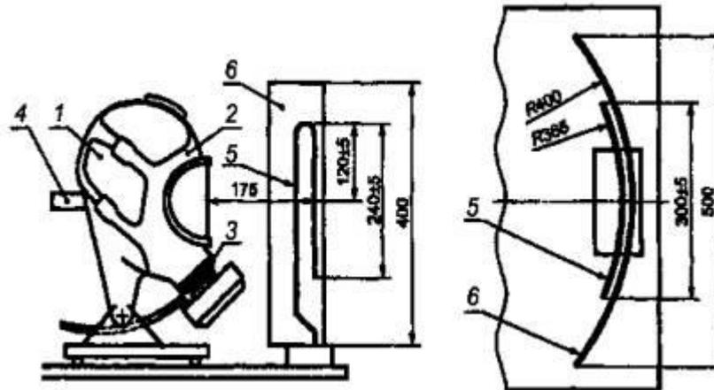
1 - металлический муляж головы человека; 2 - лицевая часть; 3 - легочный автомат; 4 - патрубков для подключения насоса «искусственные легкие»; 5 - источник теплового излучения; 6- рефlector
